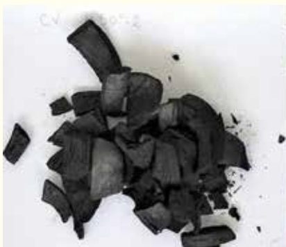
Figura 2. Biocarvão e bio-óleo de cascas de coco verde obtidos via pirólise. Fotos: Edcléa do Nascimento Reis
