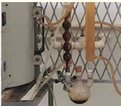
Figura 2. Biocarvão e bio-óleo de cascas de coco verde obtidos via pirólise. Fotos: Edcléa do Nascimento Reis
